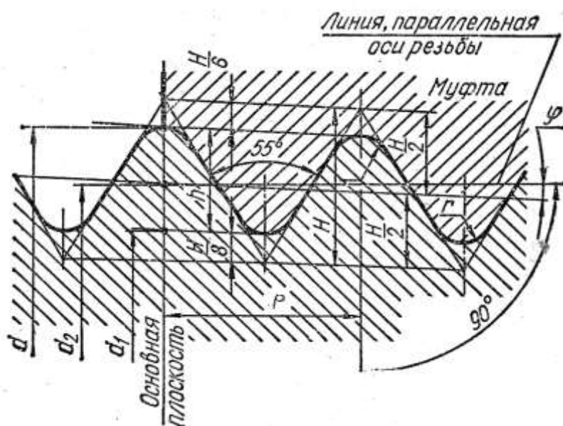
Рисунок 2.30 – Трубная коническая резьба
